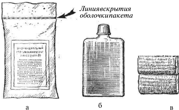
Рис. 25. Индивидуальный противохимический пакет ИПП-8: о — общий вид; б — флакон с жидкостью; в — ватно-марлевые тампоны
